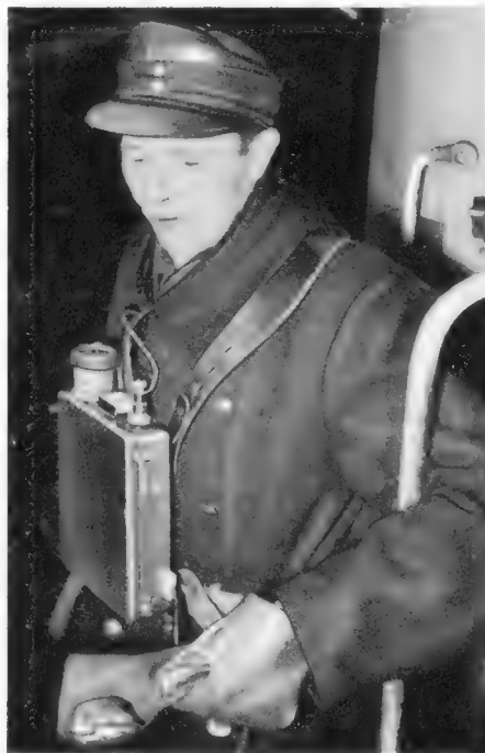
Oben: Bild 2. Das Teleport IV im Rangierbetrieb. Das Stromversorgungsgerät wird auf dem Rücken getragen
