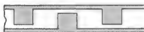
Bild 1. Anordnung der beiden Kondensator-Beläge auf der gleichen Seite des Papierbandes (getönte Fläche = Metallbelag)
