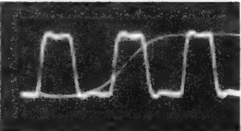
Bild 16. Rechteckfrequenz von 500 kHz am Ausgang eines Video-Verstärkers
